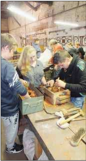
Les lycéens ont participé aux moulages au sable dans des châssis.
